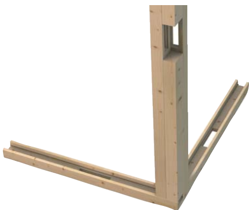
Fertig montierte Ecke in SödraSmart Bodenständern mit zwei Stück massiven Ständern 45x75 mm montiert um eine Öffnung für Kabelleitungen um die Ecke zu haben.
